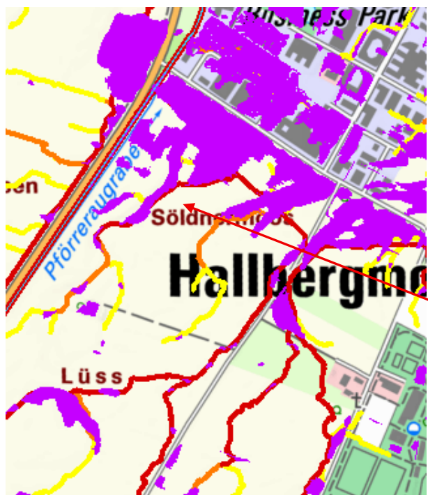
Abb. 3 Oberflächenabfluss und Aufstaubereiche /R1/
