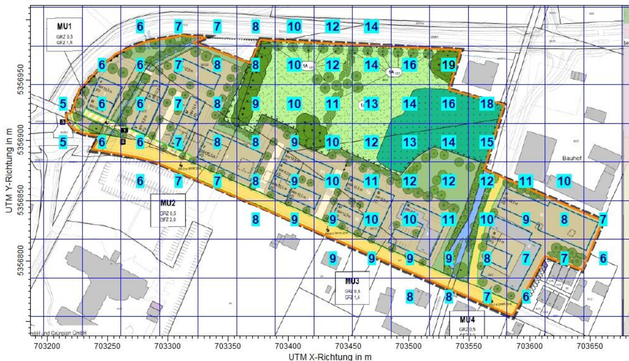
Abbildung 3: Gesamtbelastung IG durch den Betrieb der Kläranlage in % der Jahresstunden, Seitenlänge: 32 m
